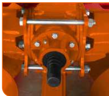
Grupo central de transmisión de potencia.
