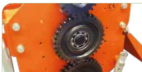
Transmisión por engranajes.
