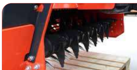
Púas y rodillo alimentador independiente y regulable.
