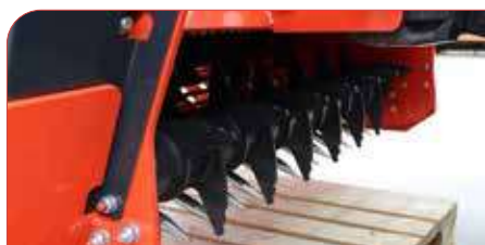
Púas y rodillo alimentador independiente y regulable.
