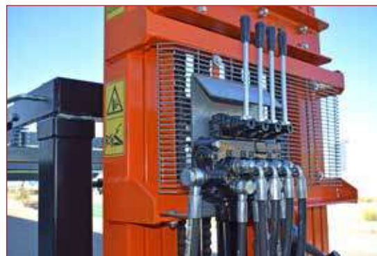
Control hidráulico de la ES70697
