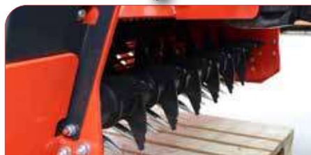
Púas y rodillo alimentador independiente y regulable.
