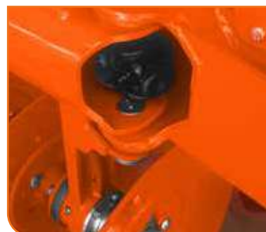
Detalle de cardan interno.
