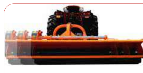
Desplazamiento horizontal de hasta 500 mm. Apertura ajustable
