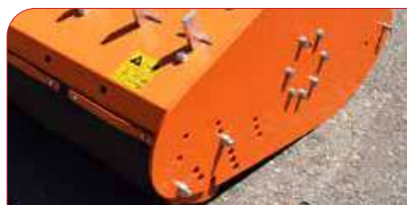
Rastrojeros, patines y rodillo regulables en altura.
