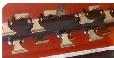
Martillos y eje de 170 mm.
