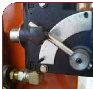
Regulador velocidad de alimentador.
