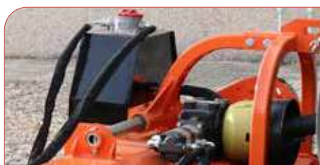
Sistema hidráulico: depósito + doble bomba
