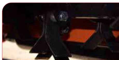
Cuchillas dobles reforzadas.
