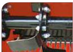
Detalle de la cuchilla y púas.
