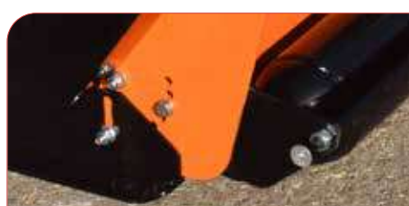
Patines ajustables en altura. Rodillo.
