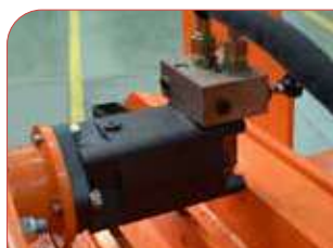
Motor hidráulico regulable del rodillo alimentador.
