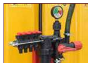
Mandos, distribuidores y manómetro. (no incluido)
